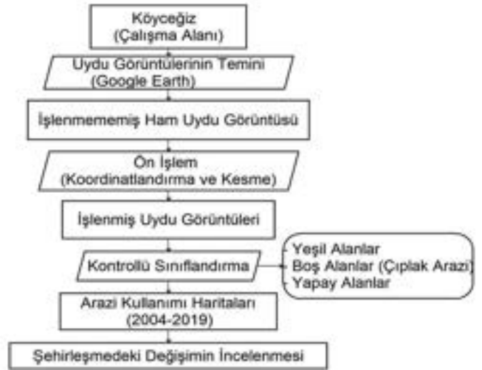
Şekil 2. Çalışmada uygulanan yöntemin akış şeması (Figure 2. Flow chart of the method applied in the study)
