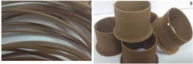
Şekil 10. (a) Geri dönüştürülmüş ahşap mobilya atığı bazlı (WPC) filament; (b) 3D yazıcıda art arda yazdırılmış masa kablosu geçiş parçası (ağırlıkça %30 ahşap bazlı filament) (Pringe ve ark. 2018).
