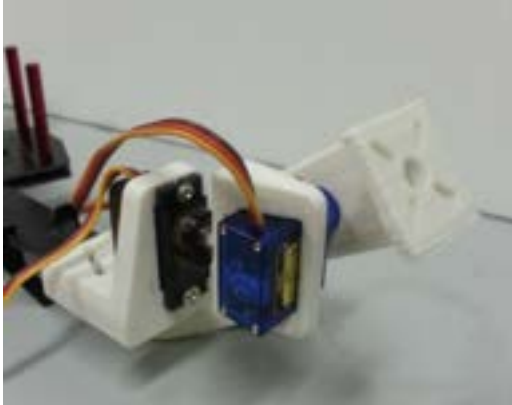
Şekil 6. Pervane dönme eksenini dışındaki iki eksende pozisyonlanabilen motor yatağı (Figure 6. A motor bearing that can be positioned about two axes other than the propeller rotation line) [15]
