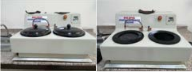
Şekil 2. Zımparalama ve parlatma cihazı (Figure 2. Sanding and polishing device)
