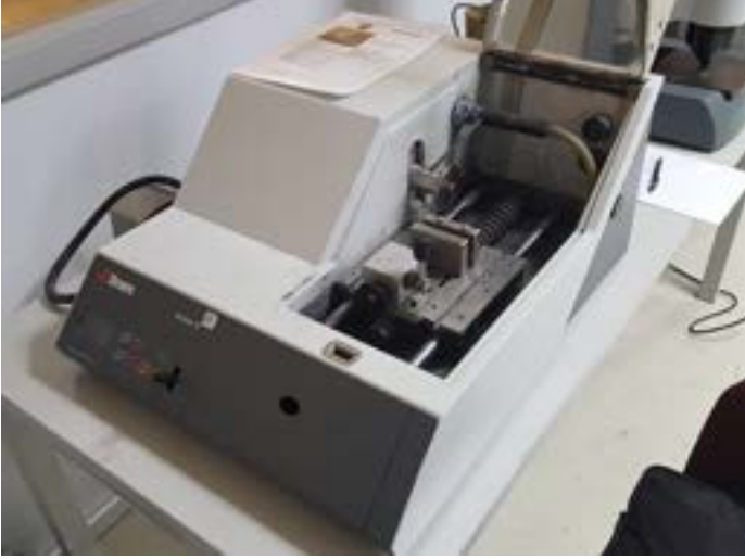
Şekil 8. Struers Secotom-10 numune kesme cihazı (Figure 8. Struers Secotom-10 specimen cutting device)
