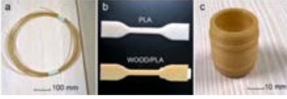
Şekil 3. (a) Ahşap bazlı filament; (b) 3D yazıcı ile üretilen WF/PLA kompozit numuneler; (c) FDM 3 boyutlu yazıcı ile yapılmış bir fiç (Tao ve ark. 2017).
