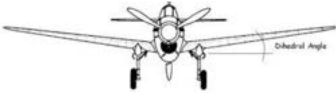
Şekil 1. Sabit kanatlı bir uçak üzerinde pozitif dihedral açısı (Figure 1. Positive dihedral angle on a fixed-wing aircraft) [6]
