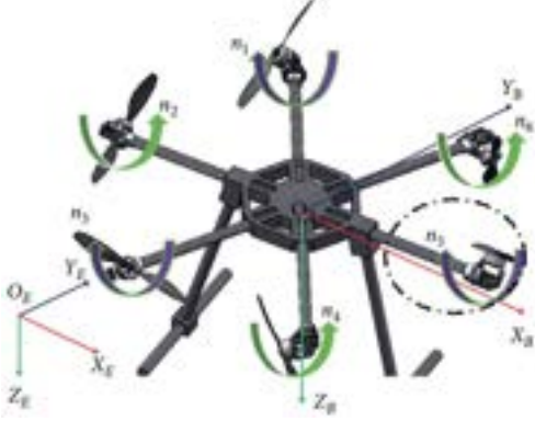
Şekil 5. Pervanelerinin eğimi birer servomotorla kontrol edilen 6 rotorlu dikuçar (Figure 5. A hexacopter whose propellers' tilt angles are controlled by a servo motor per arm) [13]
