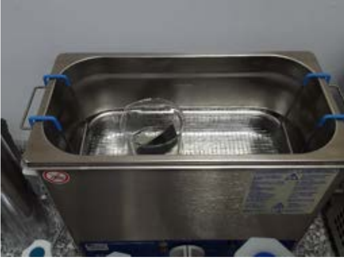
Şekil 3. Ultrasonik titreşim banyosu (Figure 3. Ultrasonic vibration bath)
