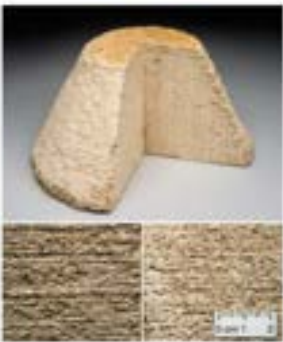
Şekil 4. Ladin ve alçıtaşı parçalarından 3D baskı ile oluşturulan kesik koni örneği (Henke ve Treml, 2012).
