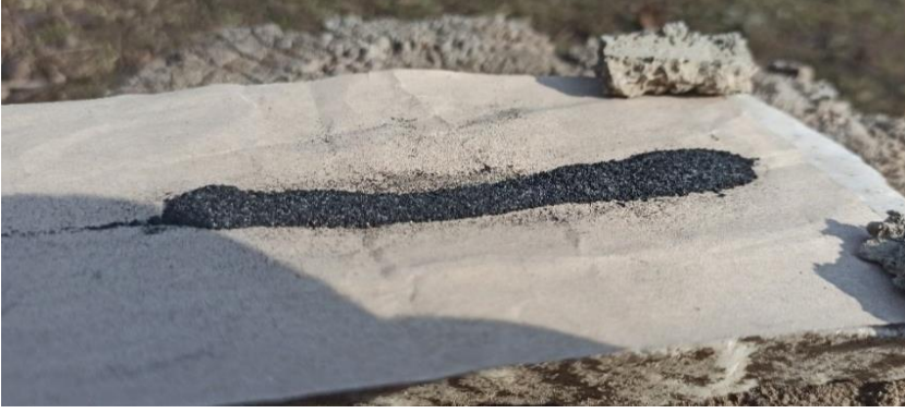
Görsel 6: Yanma testi öncesinde ilk barut örneği. Güherçile taneleri net bir şekilde görünüyor (Fotoğraf: Mustafa Salih Köksal, 18.02.2022).
