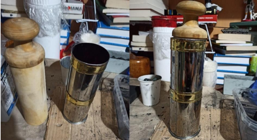
Görsel 13: Barut hamurunu sıkıştırmak için kullanılan tenek silindir ve ahşap tokmak (Fotoğraf: Mustafa Salih Köksal, 16.02.2022).
