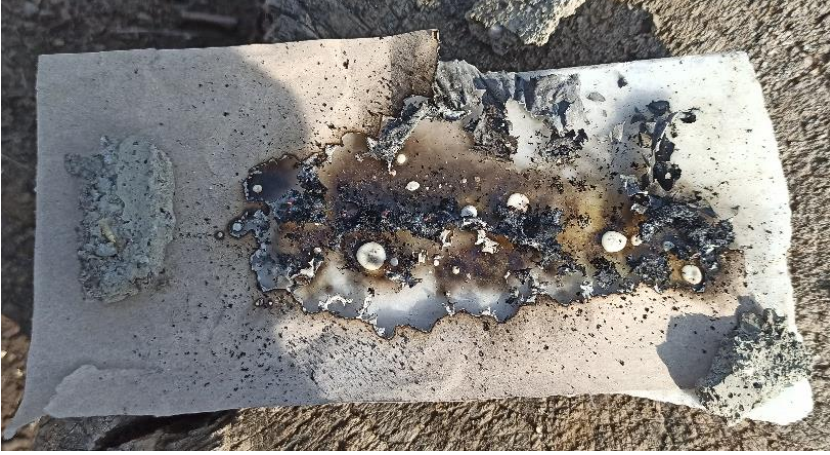
Görsel 7: Test I’in yanma testi sonrası görüntüsü. Yanma sonrasında bıraktığı iz ve etrafa sıçarttığı beyaz tanecikler görünüyor (Fotoğraf: Mustafa Salih Köksal, 18.02.2022).
