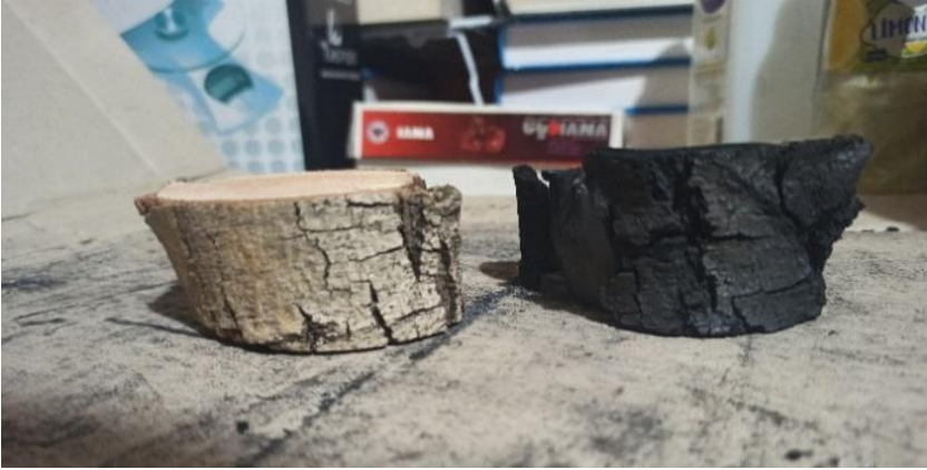
Görsel 4: Kömürleşmeden önce ve sonra söğüt ağacı parçası (Fotoğraf: Mustafa Salih Köksal, 02.07.2022).
