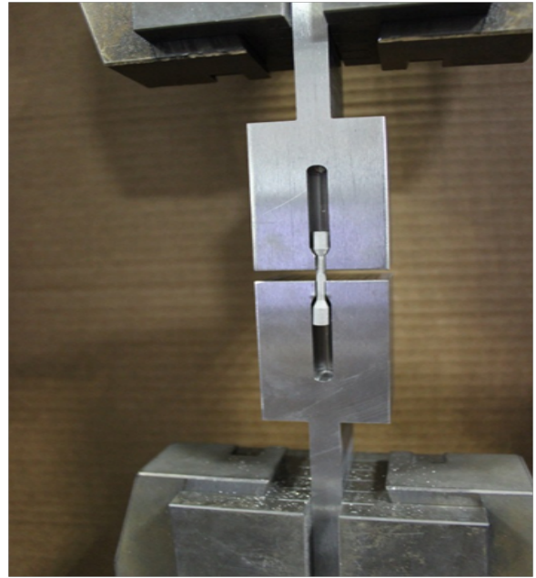
Şekil III. Numunelerin test esnasında kaynamasını önlemek için üretilen çelik tutucu aparatlar
