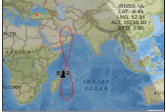
Şekil 6. IRNSS-1A uydusunun IGSO yörüngesi üzerinde herhangi bir andaki konumu (URL-9, URL-4)
