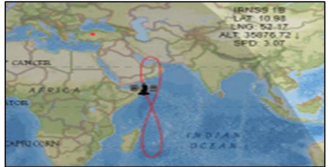
Şekil 7. IRNSS-1B uydusunun IGSO yörüngesi üzerinde herhangi bir andaki konumu (URL-12)
