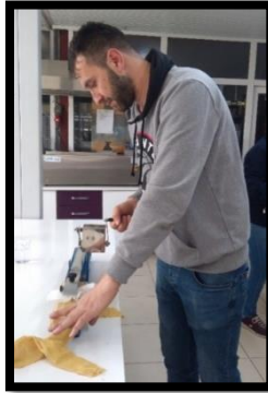
17.Görsel Sürtünme Haslığı Testi (Oğuz, 2021)
