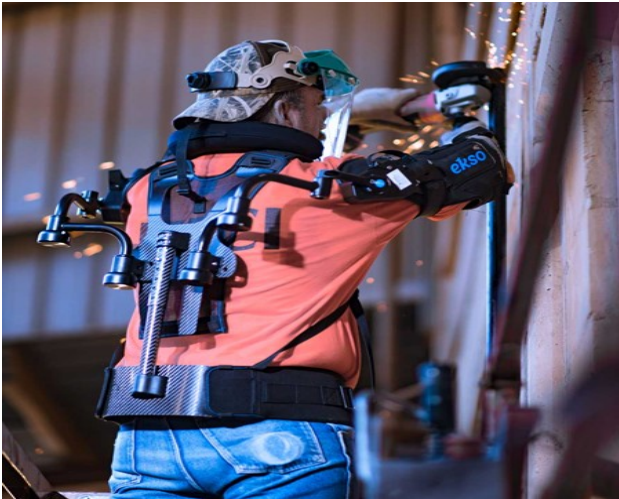
Şekil 7: EksoVestle uygunsuz pozisyonlarda çalışma [100]
