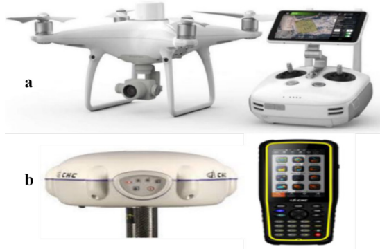
Şekil 2. İHA Sistemi: a) DJI Phantom 4 RTK, çalışmada kullanılan CHCN; b) X91 GNSS alıcısı (Eker ve ark., 2020).
