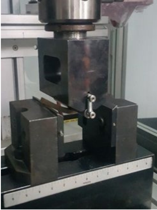
Figure 12. Bending test of bamboo-LPDE composite material under a certain load. Şekil 12. Bambu-LPDE kompozit malzemesinin belirli bir yük altında eğilme testine tabi tutulması
