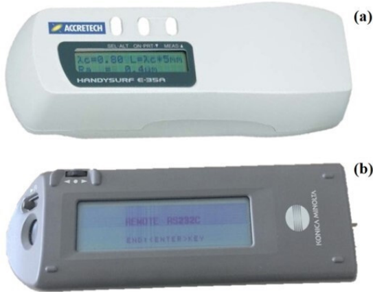
Şekil 1. Tokyo Seimitsu Accretech Handysurf E-35 B iğne taramalı portatif yüzey ölçüm cihazı (a), Konica Minolta spektrofotometre (b).
