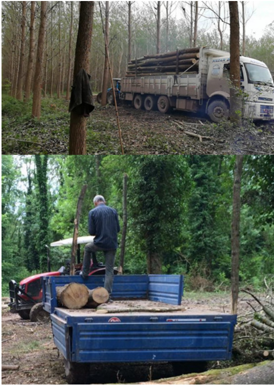
Şekil 10. Çalışma alanında uzak nakliyat araçları: üst) kamyon, alt) 4x4 tarım traktörü (2020) Figure 10. Secondary transport vehicles: truck (above), 4x4 farm tractor (below) in the study area (2020)
