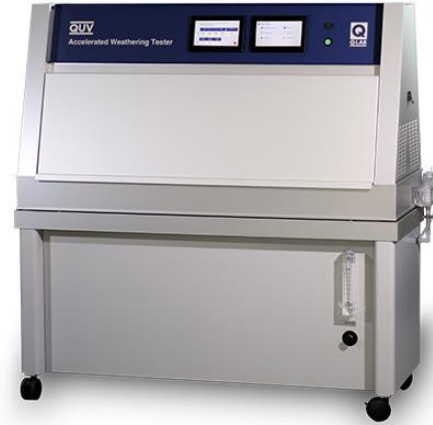
Şekil 3. Suni yaşlandırma cihazı (Djeddaoui ve ark., 2019) Figure 3. Artificial weathering device (Djeddaoui et.al. 2019)
