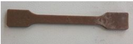
Figure 13: LDPE bamboo composite test sample with different percentages prepared for tensile testing Figure 13: Çekme testi için hazırlanmış LDPE bambu kompozit test örneği
