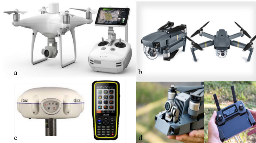
Şekil 2. İHA Sistemleri ve CHCN X91 GNSS uydusu alıcısı: a) DJI Phantom, b) DJI Mavic Pro, c) CHCN X91 GNSS uydusu alıcısı, d) DJI Mavic Pro uzaktan kumandası
