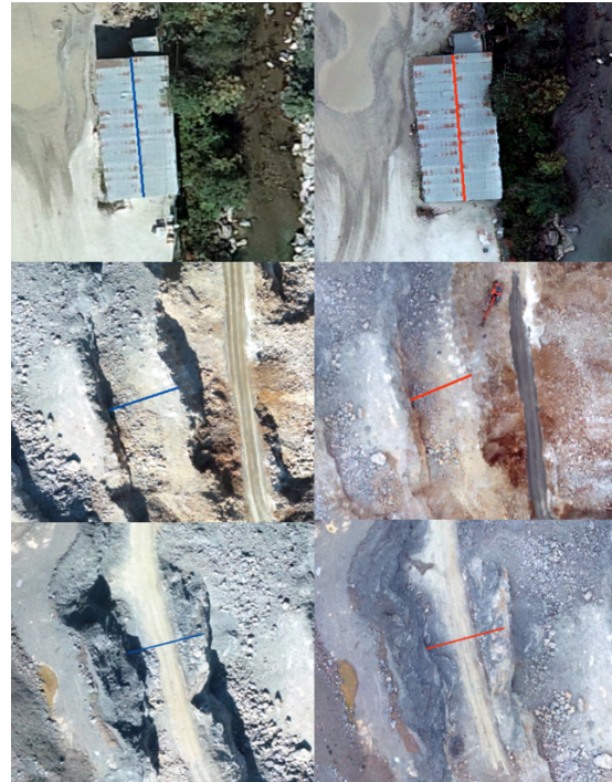
Şekil 8. PPK (solda) ve RTK (sağda) görüntülerinde belirlenen noktalardaki uzunlukların ölçümü Figure 8. Measurement of the lengths of the determined points in the PPK (left) and RTK (right) images
