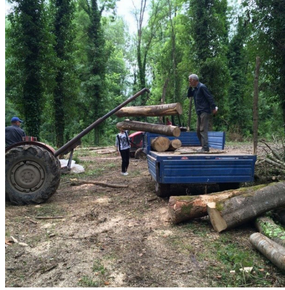
Şekil 11. Modifiye edilen tarım traktörünün (4x4) hidrolik sistemiyle yükleme Figure 11 Loading with the hydraulic system of the modified farm tractor (4x4)
