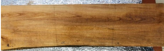
Şekil 3. Deney örneğinin teğet kesitinden bir görünüş Figure 3. A view from the tangential section of the test sample
