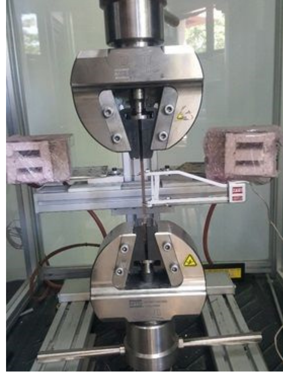
Figure 14. Tensile testing of bamboo-LPDE composite material with the aid of an extensometer under a certain load Şekil 14. Bambu-LPDE kompozit malzemesinin belirli bir yük altında ekstansometre yardımıyla çekme testine tabi tutulması
