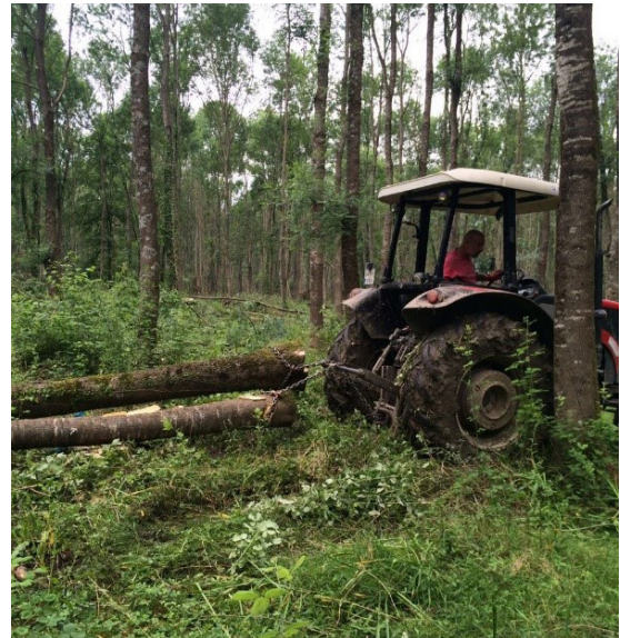
Şekil 8. Tarım traktörüyle bölmeden çıkarma (2020) Figure 8. Extracting by farm tractors (2020)
