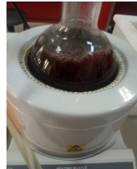
Şekil 1. Mantolu ısıtıcı yardımı ile bitki ekstraksiyonunun gerçekleştirilmesi
