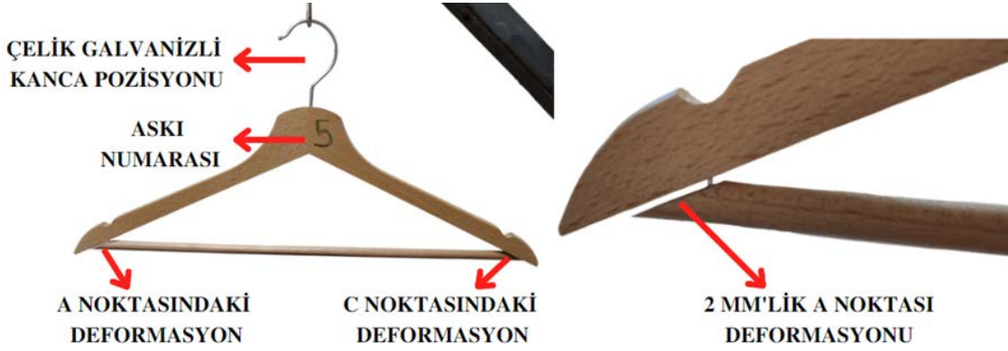
Şekil 3. Örnek ahşap elbise askısı deformasyon görseli
