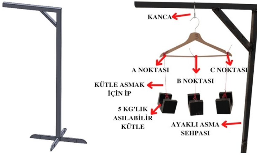
Şekil 2. TSE 9215'e göre ayaklı asma sehpa deney düzeneği
