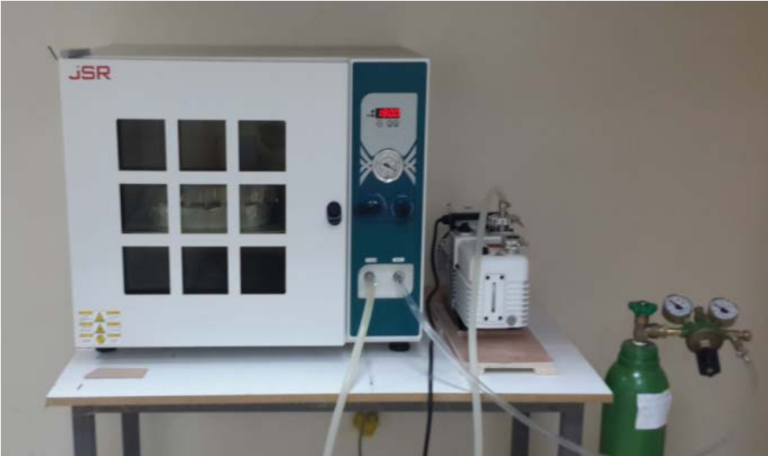
Şekil 2. Çalışmada kullanılan vakumlu etüv, vakum pompası ve gaz beslemesi
