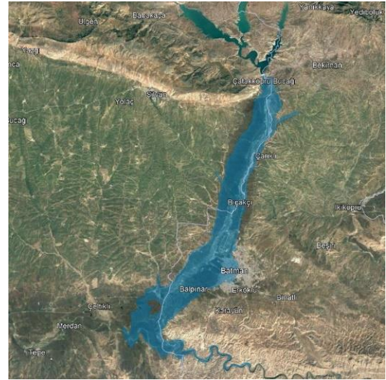
Şekil 8. Batman Barajı yıkılması sonrası oluşmuş muhtemel taşkın dalgası
