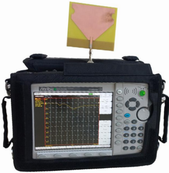
Şekil 8. Anritsu MS2028C vektör network analizör cihazı.
