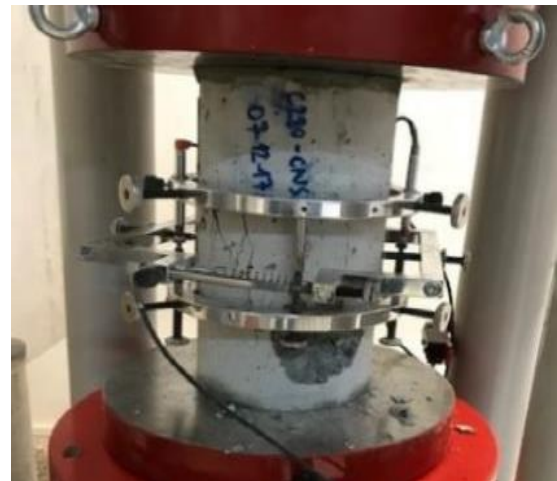
Şekil 2. Basınç deneyinde kullanılan çerçeve sistemi.
