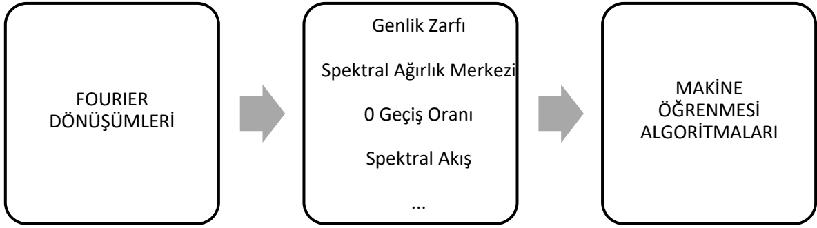
Şekil 4. Ses verileri için geleneksel makine öğrenmesi akışı
