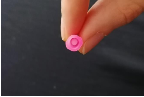
Şekil 3. Filtreli İğnenin Ajutaj Kısımındaki Filtrenin Görünümü (Nida Nur Söğüt'ün arşivinden)
