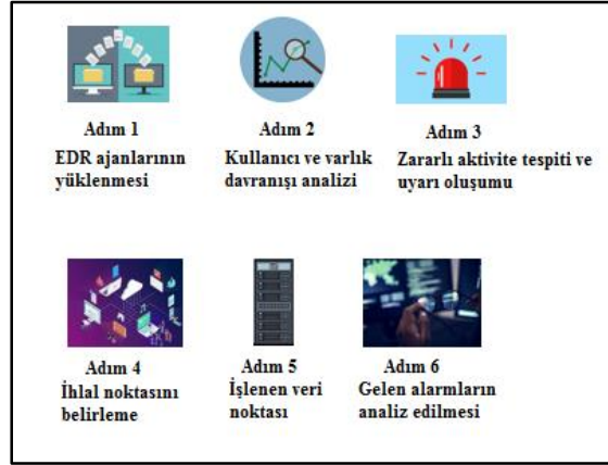
Şekil 1 EDR Ürünü Çalışma Yapısı
