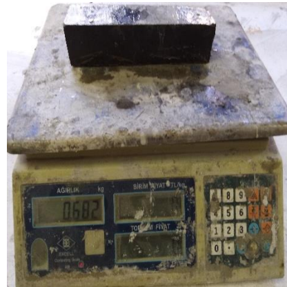
b) Numunelerin havadaki ağırlıklarının ölçülmesi
