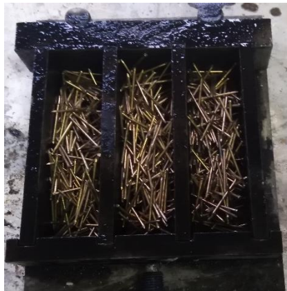
a) Çelik liflerin kalıba yerleştirilmesi
