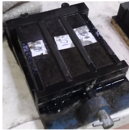
b) Çimento bulamacının kalıba yerleştirilmesi
