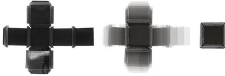
Şekil 5. Üç boyutlu bir küp halinde katlanabilen 4D baskılı Tel (4D Printed wire that can be folded into a three-dimensional cube) (Tibbits, 2014)
