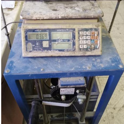
a) Numunelerin su içerisindeki ağırlıklarının ölçülmesi
