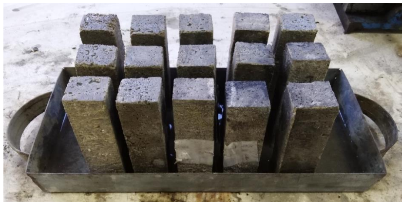
Şekil 4. Kılcal su emme katsayısı deneyi (Capillary absorption coefficient test)
