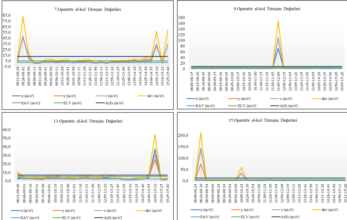
Şekil 4. 7,9,13,15 No’lu Operatörlerin 8 Saatlik Titreşim Değerleri Grafiği (8-Hour Vibration Values Graph For Operator 7,9,13,15)
