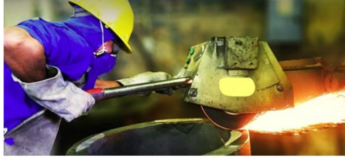
Şekil 9. Askılı Taşlama Operasyonu (Swing Frame Grinding Operation)
