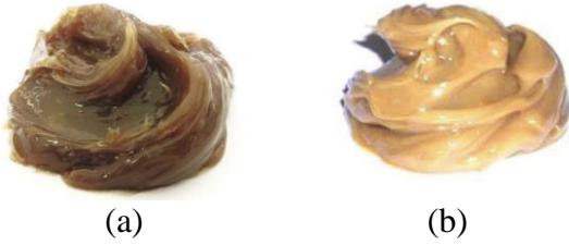
Şekil 2. a) Basit kalsiyum sülfonat gres, b) Kompleks kalsiyum sülfonat gres [9]
