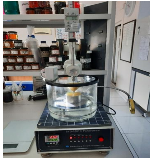
Şekil 4. Penetrasyon analiz cihazı (SYD-2801C tipi Shanghai Changji Geological)
