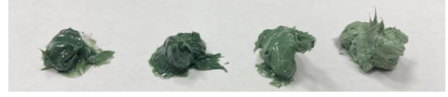
Şekil 5. %0 (sol), %1 (orta sol), %10 (orta sağ) ve %50 (sağda) su ile kirlenmiş kalsiyum sülfonat gresi
