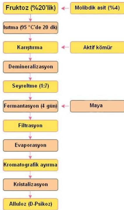
Şekil 3. Kimyasal yöntemle fruktozdan alluloz üretimi akış şeması [21]
