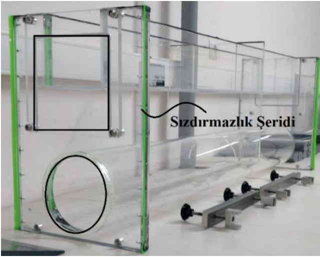
Şekil 5. Deneysel çalışmalarda kullanılan menfez tipleri ve sızdırmazlık şeritleri
