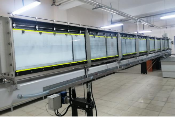
Şekil 7. Deneysel kanalda yeşil şeritlerin kullanımı
