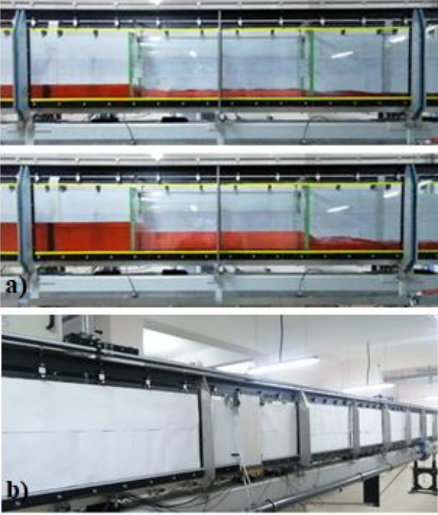
Şekil 4. a) Farklı durumlar için deneysel çalışmalara ait görüntüler b) kanal arka duvarının beyaz kağıtla kaplanması
