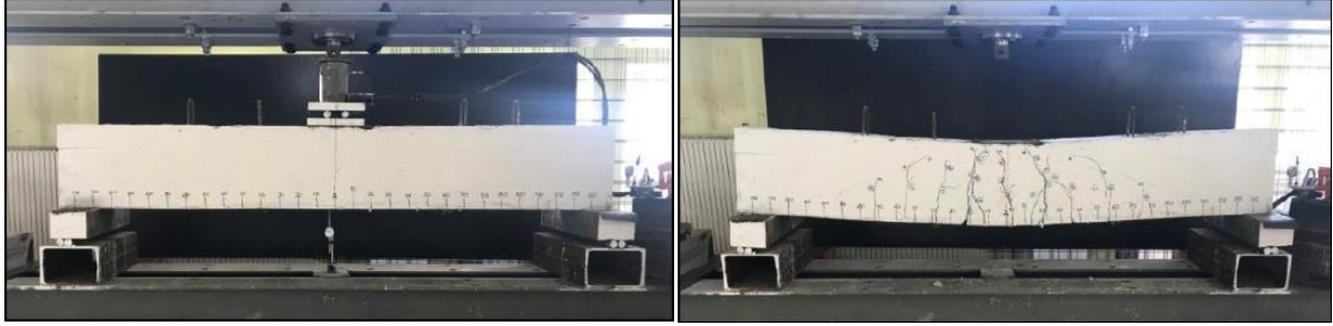
Şekil 12. K3 kirişi (döşeme donatısız) ve göçme şekli.
