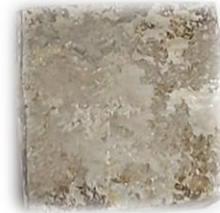
Şekil 8. ZW21 döküm alaşımının 72 saat sonra Daldırma görüntüsü.
