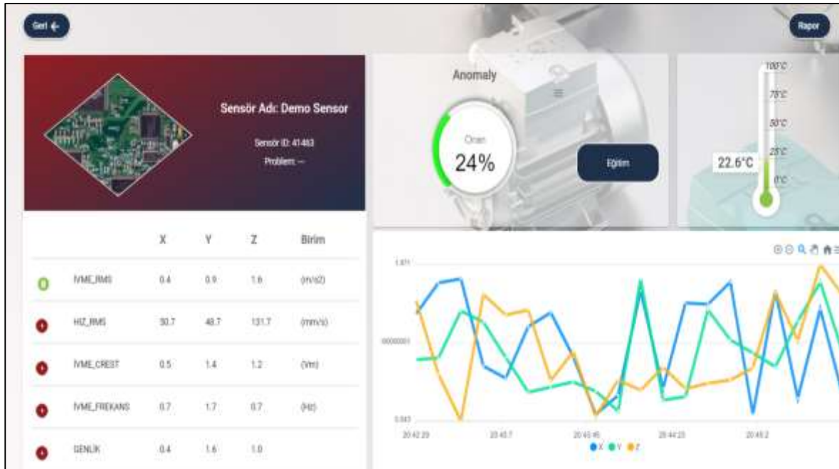
Şekil 7. Gömülü sistem mikrodenetleyici sensör kartından buluta ulaştırılan titreşim verileri
