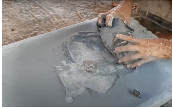
Görsel 15: Kil ile külün yoğrulma aşaması (URL-13) Video ekran görüntüsü 3.39 sn.
