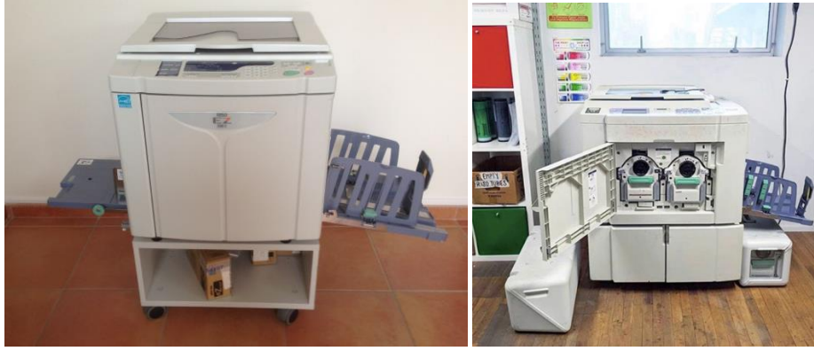
Görsel 1. Riso baskı makinası dış görünüş ve iç görünüşü.
