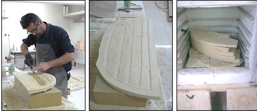
Görsel 13. Pano kurduktan sonra parçaların arka yüzeylerine kanallar açılması ve bisküvi pişirimi için fırına yerleştirilmiş pano parçaları.
