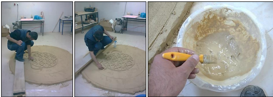
Görsel 9. Şerit plaka ve parçalarının yüzeye eklenerek ana kabartma deseninin oluşturulması ve yapıştırma işleminde kullanılan balçık.
