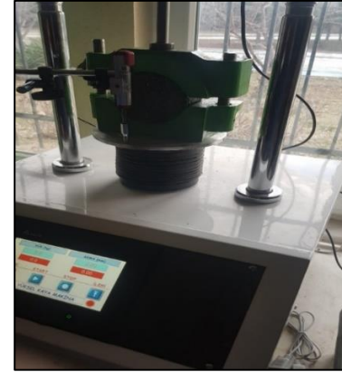
Şekil 4. Marshall stabilite ve akma cihazı
