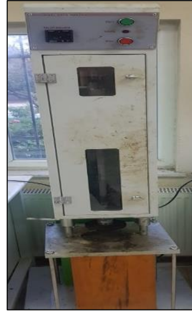
Şekil 3. Marshall sıkıştırma cihazı
