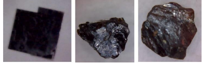
Şekil 5. Galen Numunesinde Sırasıyla Çeneli, Konili ve Merdaneli Kırıcı Çıkışı (-2+1 Mm) Tanelerin Görünümü
