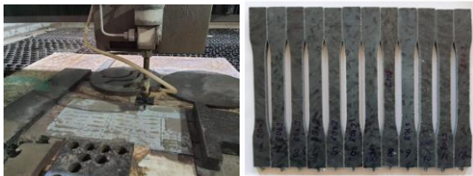
Şekil 10: Su jeti yardımıyla çekme testi numuneleri eldesi
