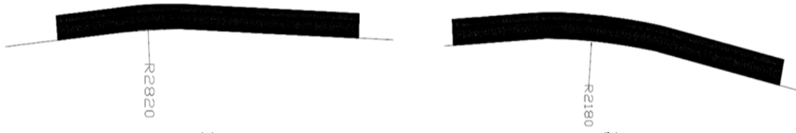
Şekil 7. (a) İçi boş büküm sonrası radyus değeri, (b) İçi dolu büküm sonrası radyus değeri.
