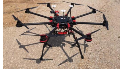
Şekil 1. Karbon fiber kompozitten üretilmiş bir octocopter İHA gövdesi (Villi, 2019).
