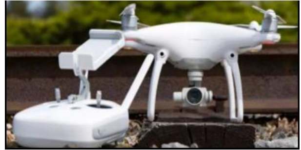
Şekil 8. DJI Phantom Pro4 ve Entegre Dijital Kamera
