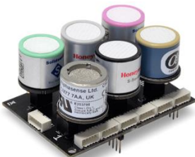
Şekil 12. İHA'larda kullanılabilen çoklu gaz ölçüm ünitesi (Libelium, 2015).
