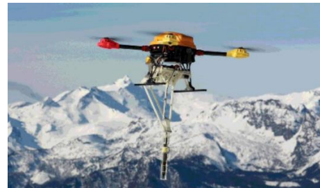
Şekil 19. Çığ kurtarma operasyonları için geliştirilen İHA (Silvagni vd., 2017).
