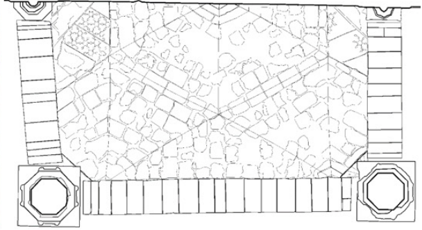
Şekil 21. 180° açılı kenar tonozun planı (VGM).
