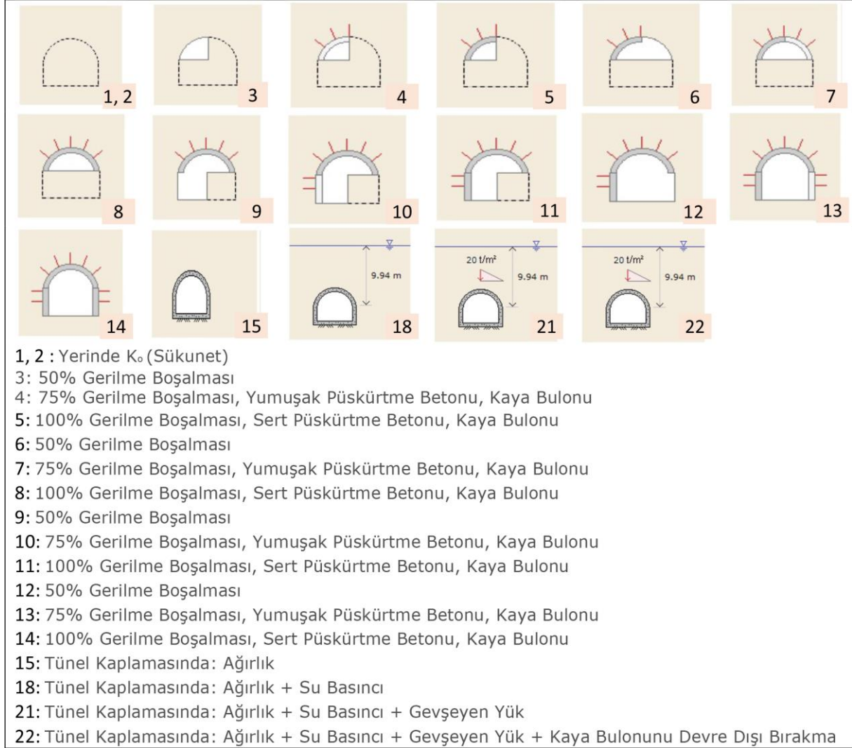
Şekil 3. Tasarlanan tünelin kazı adımları.
