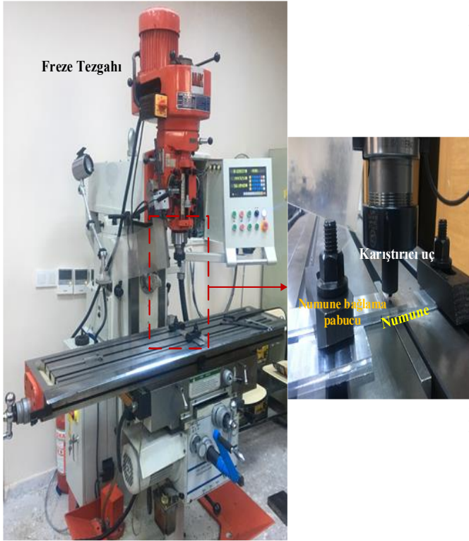
Şekil 3. Kaynak işlemlerinin yapıldığı Freze tezgâhı
