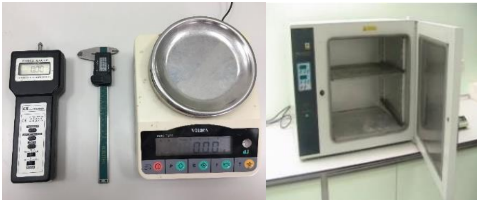
Şekil 1. Ölçümlerde kullanılan kuvvet ölçer, kumpas, terazi ve etüv
