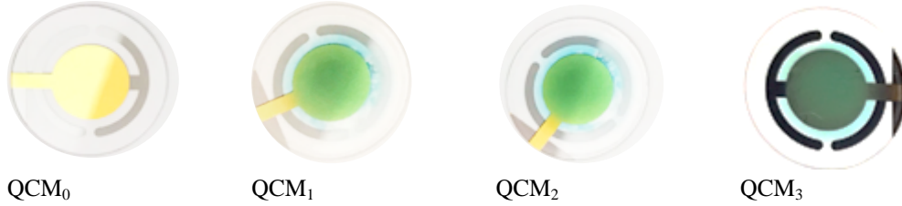
Şekil 3. QCM 0 Kaplamasız Sensör, QCM 1 , QCM 2 Ve QCM 3 ) Kaplamalı Sensörler.
