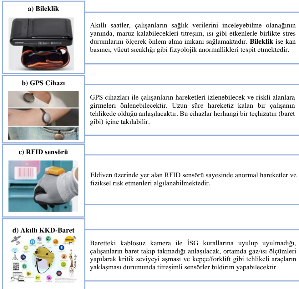
Şekil 2. Giyilebilir Cihazlar ve Akıllı Kişisel Koruyucu Donanım Örnekleri (Öztürk, 2020; Topaloğlu ve Şahin, 2021; a) “RFID Çözümler, bt; b) “Wildcraft Enters Wearable”, bt; c) “RFID Ürünler, bt; d) “Tekno Akıllı Baret”, bt).
