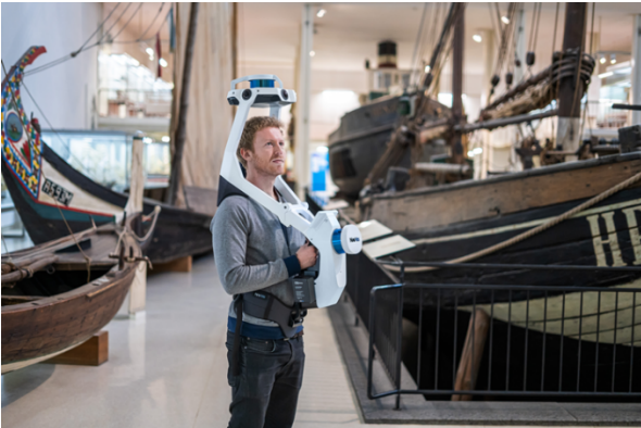
Şekil 2.6. Navvis GML tarayıcı bir gemi müzesinde tarama yaparken (Lauter, 2020).
