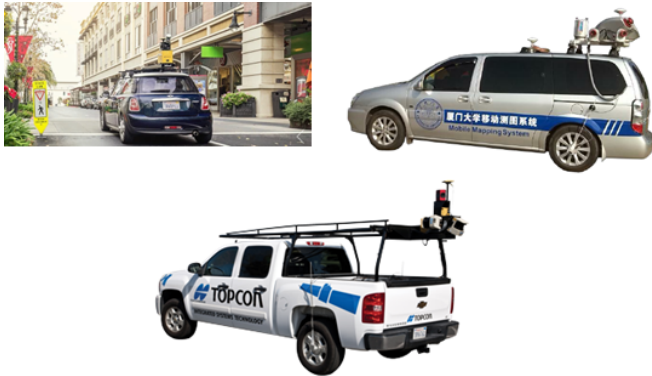
Şekil 2.3. Farklı araçlara monte edilmiş mobil lazer tarayıcılar (Paksoytekniik, 2021; Yu, 2014).
