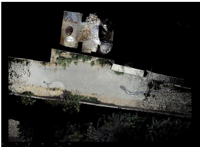
Şekil 8. PointCab Origins 3.9 adlı programında yapının ölçekli ortofotoları(dik foto) elde edilmesi (Kat planları)
