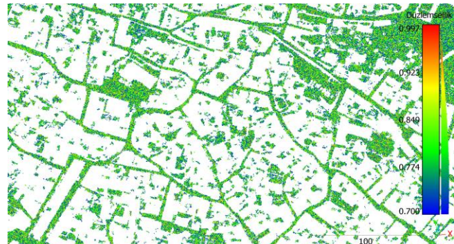
Şekil 6. Düzlemsellik analizi sonrası limit uygulaması 0.7 ve üzeri düzlemselliğe sahip noktalar.
