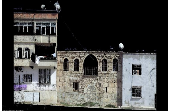
Şekil 9. PointCab Origins 4.0 adlı programında yapının ölçekli ortofotoları (dik foto) elde edilmesi (Güney Cephesi)
