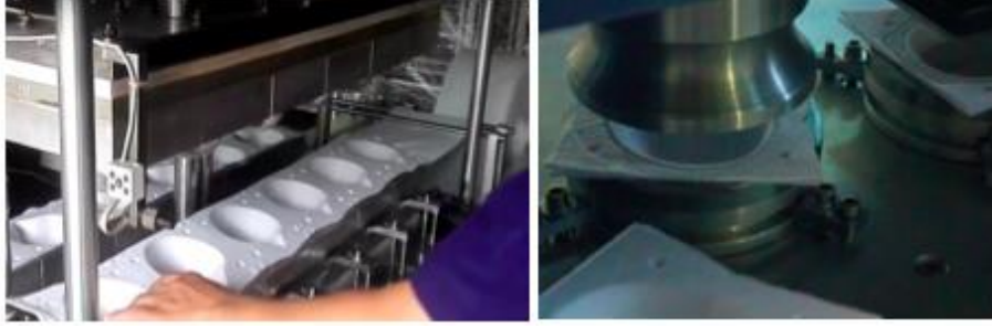
Şekil 18. Maske kalıplama ve maske katmanlarını yapıştırıp fazlalık kesme
