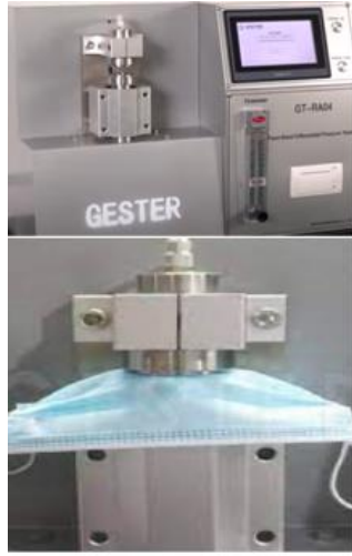
Şekil 25. Delta P Basınç Farkı Testi Cihazı (Gester Marka)
