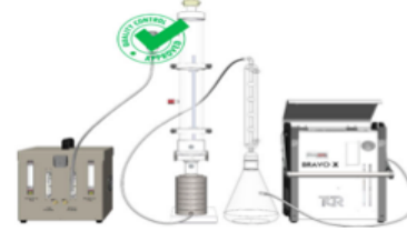
Şekil 21. Bakteriyel Filtrasyon Verimliliği (BFE) Test Düzenegi https://www.astm.org/DATABASE.CART/HISTORICAL/F2101-01.htm
