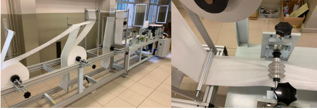
Şekil 14. Düz filtreli maske üretimi (AKS Teknik maske makinesi, RAML Atölyesi)
