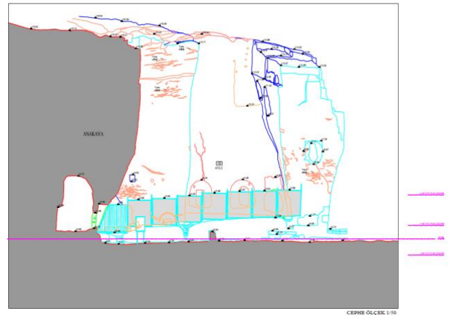
Şekil 18. Cephe üzerindeki taş malzeme bozulmaları
