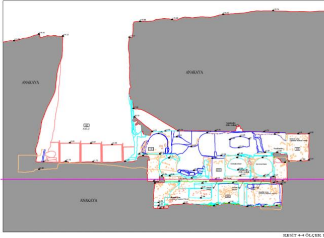
Şekil 15. 4-4 Kesiti'nde taş malzeme bozulmaları
