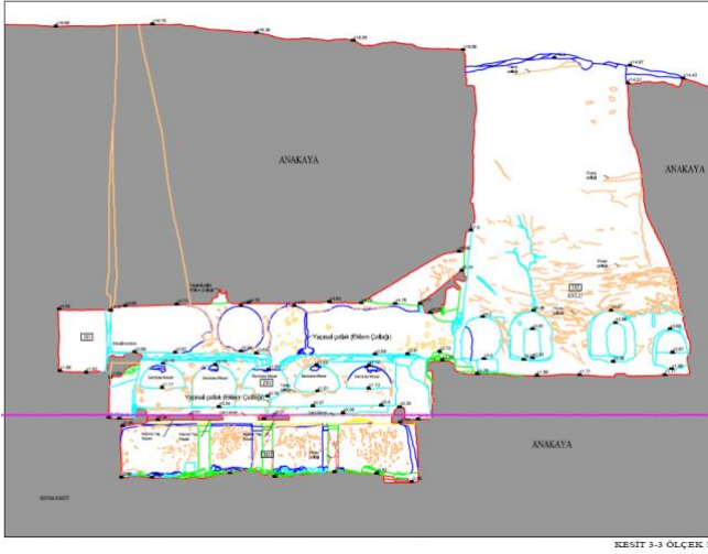
Şekil 14. 3-3 Kesiti'nde taş malzeme bozulmaları
