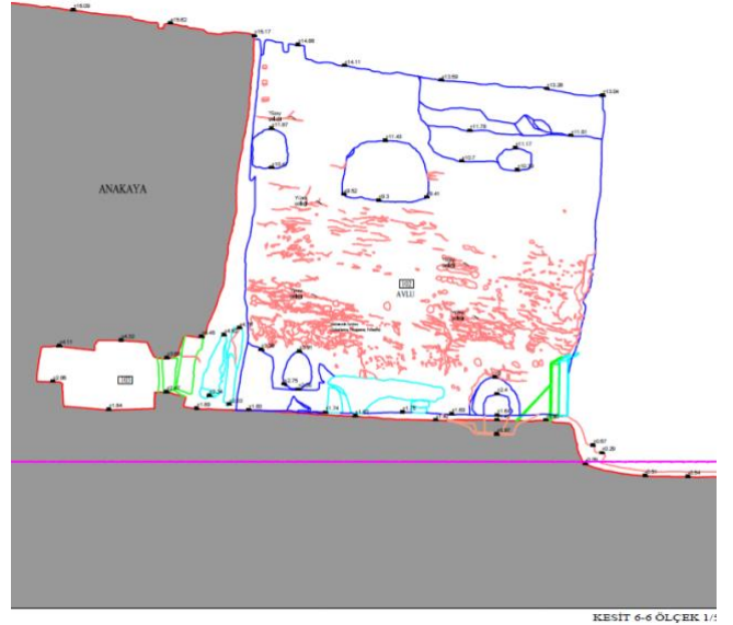
Şekil 17. 6-6 Kesiti'nde taş malzeme bozulmaları
