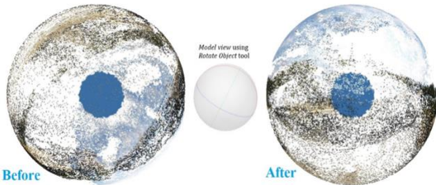
Şekil 14. Hizalanmış görüntülerin bulut yönünün düzeltilmiş hali.
