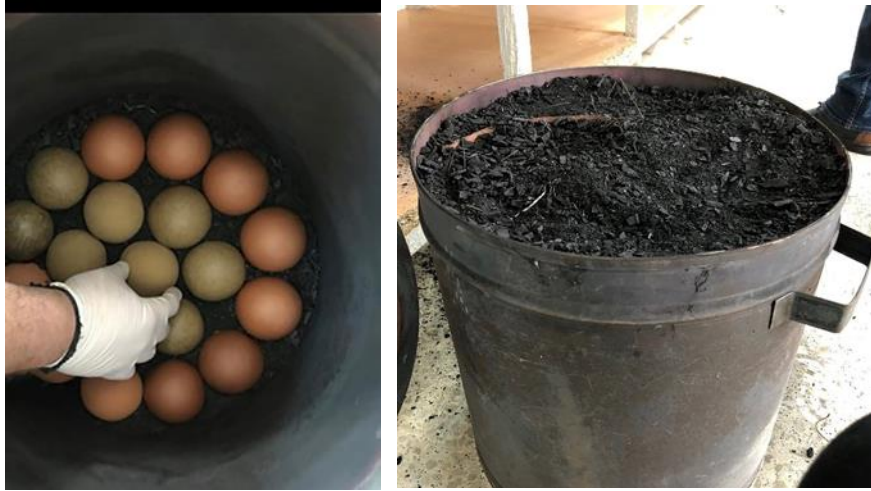
Görsel 12. Deney numunelerinin Krom Nikel kaba yerleştirilmesi
