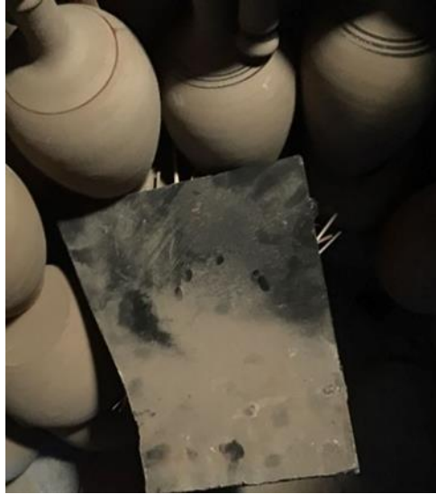
Görsel 7. Karartılacak ürünlerin konduğu üzeri kapatılmış tenekenin, diğer ürünlerle birlikte fırın içi görünümü (Fotoğraf: Erdem Aybar)
