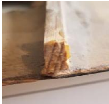
Resim 5: 1904 tarihli Manol ud kiriş ve ses tablası lif yönü kesiti
