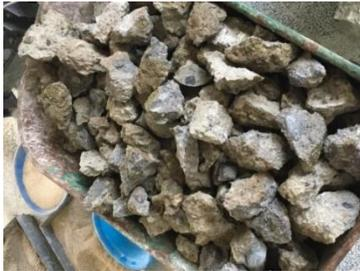
**Şekil 1.** İnşaat yıkıntı atıkları
