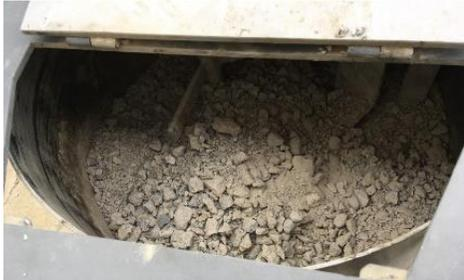
**Şekil 5.** Kuru malzemelerin betoniyerde karıştırılması
