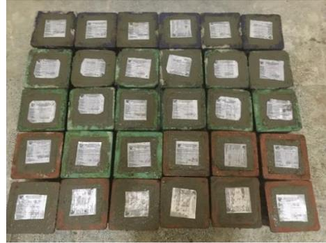
**Şekil 7.** Kalıplara karışım betonunu yerleştirilmesi
