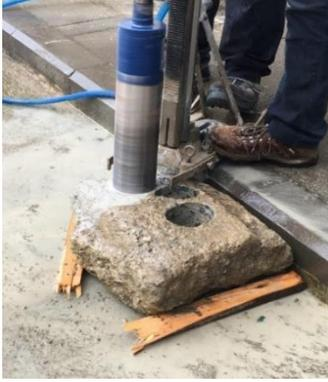
**Şekil 4.** Atık beton kütlelerinden karot numunelerinin alınması
