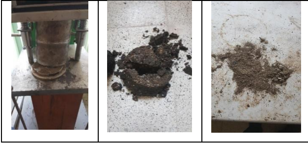
Şekil 8. Diatomit filler oranı %100 olan numunenin sıkıştırma işlemi ve sonrası
