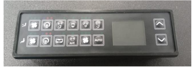
Şekil 2. HVAC Kumanda Paneli
