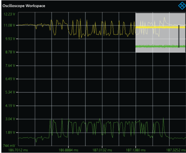
Şekil 9. TVS koruma devresi osiloskop çıktısı
