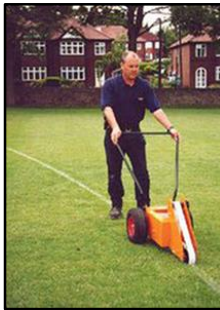
Şekil 14. “Truline” kayış/bant transferli çizgi işaretleyici (URL-4)
