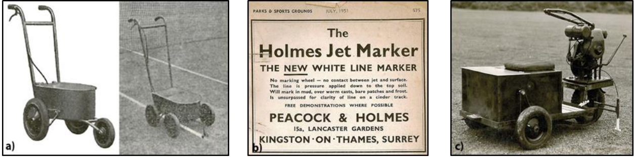
Şekil 2. a-b) “Holmes Jet Marker” Holmes püskürtmeli çizgi işaretleyici c) Motorlu püskürtmeli çizgi işaretleyici (Harrod, 2018)
