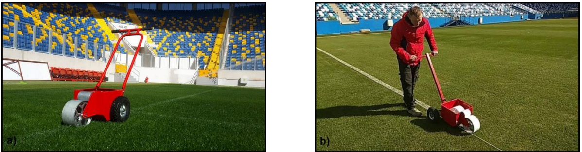
Şekil 16. Aktarmalı (tekerlekten tekerleğe) çizgi işaretleyici a) Eryaman Stadyumu (Yazar arşivi) b)
