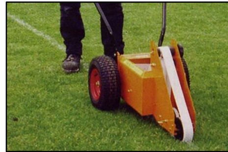
Şekil 14. “Truline” kayış/bant transferli çizgi işaretleyici (URL-4)
