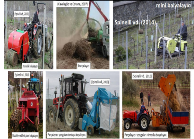
*Yuvarlak balyalayıcı / The round baler, Parçalayıcı / The shredder, Mini balyalayıcı / The mini baler, Modifiye edilmiş kare balyalayıcı / The modified square baler, Parçalayıcı yongaları torbaya boşaltılıyor / The shredder is discharging chips into the bag, Parçalayıcı yongaları römorka boşaltılıyor / The shredder is discharging chips into the trailer
