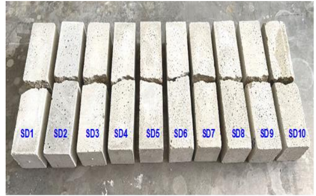
Şekil 9. Eğilme dayanımı sonrası ÇEKYTS test örneklerinin sembolik genel görünüşü
