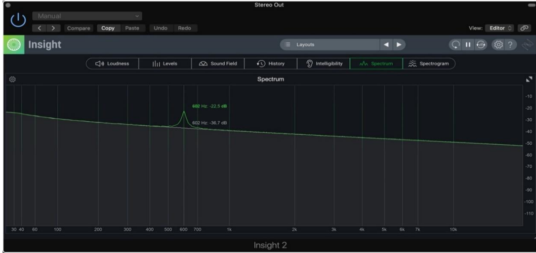
Resim 4. Logic Pro X' in Varsayılan EQ Eklentisinde Yükseltilen 600 Hz Frekansının, Ses Sinyaline Olan Etkisi
