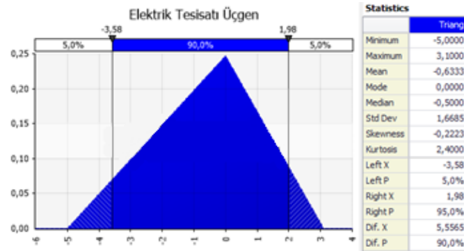
Şekil 13. Elektrik tesisatı için öngörülen maliyetin üçgen dağılım ile oluşturulan olasılık dağılımı
