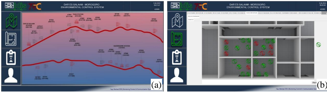
Şekil 9. Projenin SCADA sisteminde (a) alarm sisteminin genel görünüşü ve (b) istasyon görünüşü
