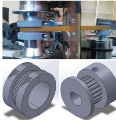
Şekil 4. Araçın güç aktarımı için tasarlanan dişli mekanizması
