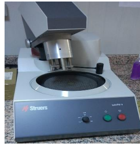
Şekil 9. Struers LaboPol-5 Zımparalama ve parlatma cihazı [5]
