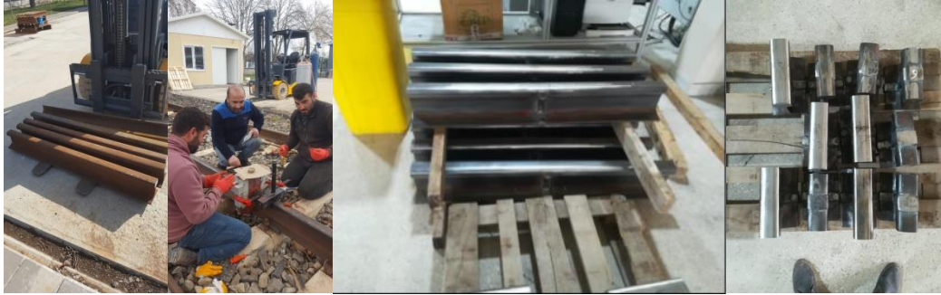
Şekil 2. Hazırlanan R350HT ray numuneleri [7]
