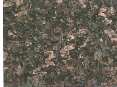
d) 100X Ray Tabanı-Kaynaklı Bölge-Ana Yapı-Perlitik Tane Sınırlarında Ferritler
