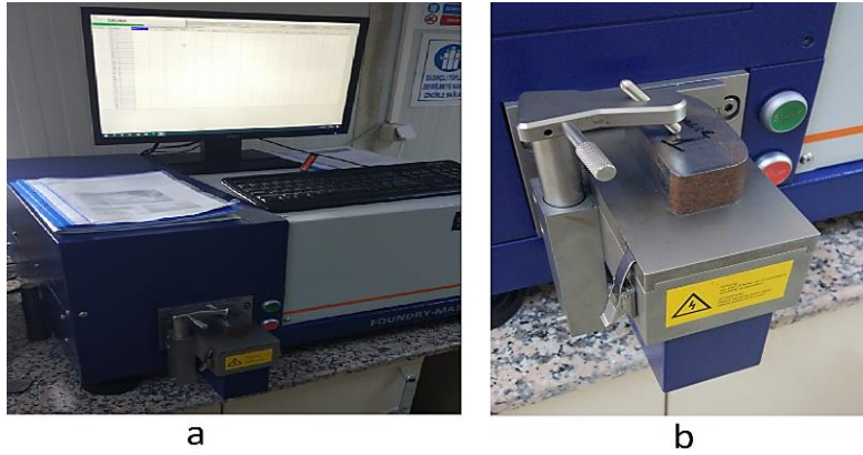
Şekil 10. Optik Emisyon Spektrometresi; a) Spektrometre dış görünümü ve deneye hazırlık b) Spektrometreye numunenin bağlanması ve deney aşaması [5]
