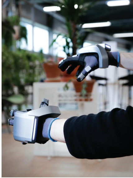
Görsel 7: Sanal Gerçeklik Ortamında Nesnelerin Ellerle Hissedilebilmesi için Tasarlanmış SensGlove Nova Eldivenleri
