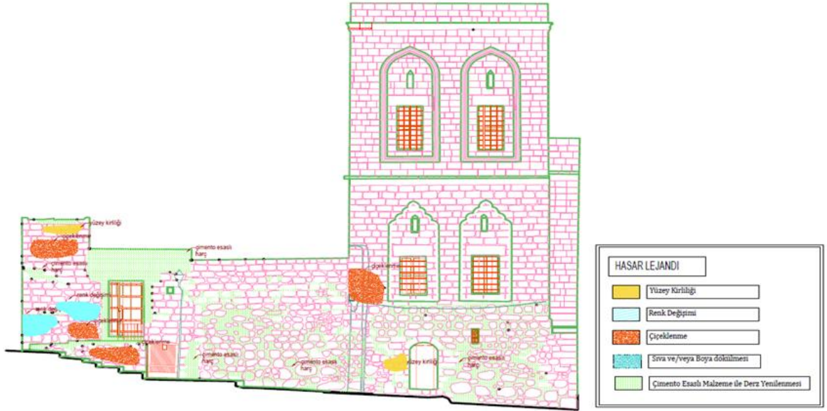
Şekil 9. Yapının doğu cephesinde malzeme bozulmalarına dair analitik rölöve
