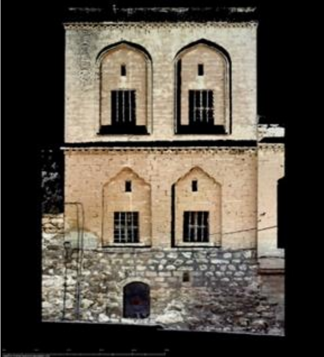
Şekil 7. PointCab Origins 4.0 adlı programında yapının ölçekli ortofotoların elde edilmesi (Doğu Cephesi)
