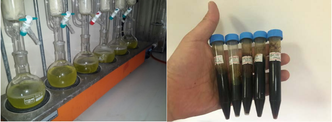
Şekil 2. Yağ analiz cihazında (sokshalet) ekstraksiyon işlemi ve pamuk yağı örnekleri.
