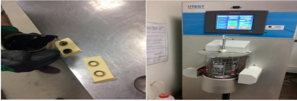
Şekil 3.3 Yumuşama noktası deney numunesi ve deney cihazı
