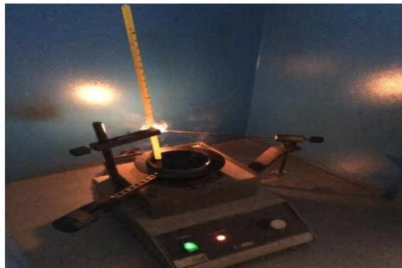
Şekil 3.2 Parlama noktası deney cihazı ve numunesi
