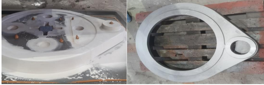
Şekil 12. İyileştirilmiş Tasarım Modeli ve Bu Ürüne Ait Gerçekleştirilen Döküm
