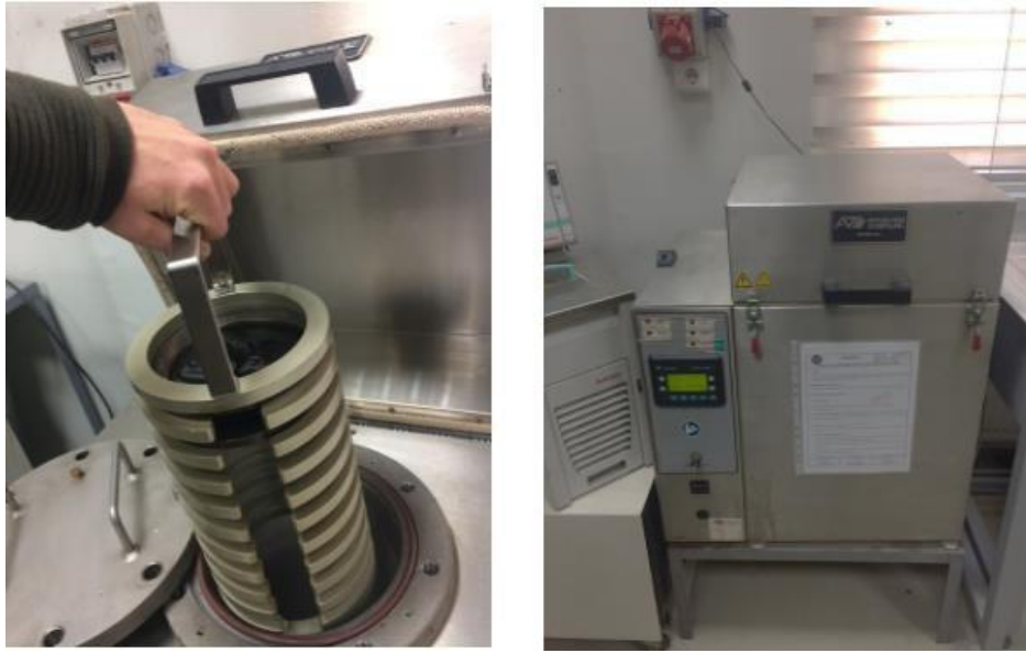
Şekil 3.6 Yaşlandırma deney cihazı açık ve kapalı hali
