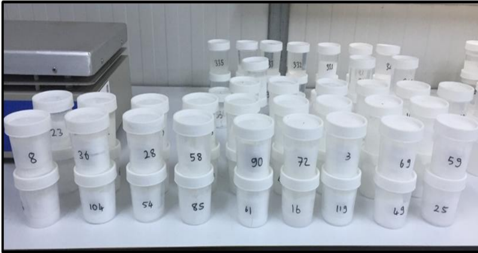
Şekil 1. Sodyum silikat formamit solüsyonlarında jelleşme sürelerinin gözlemlenmesi
