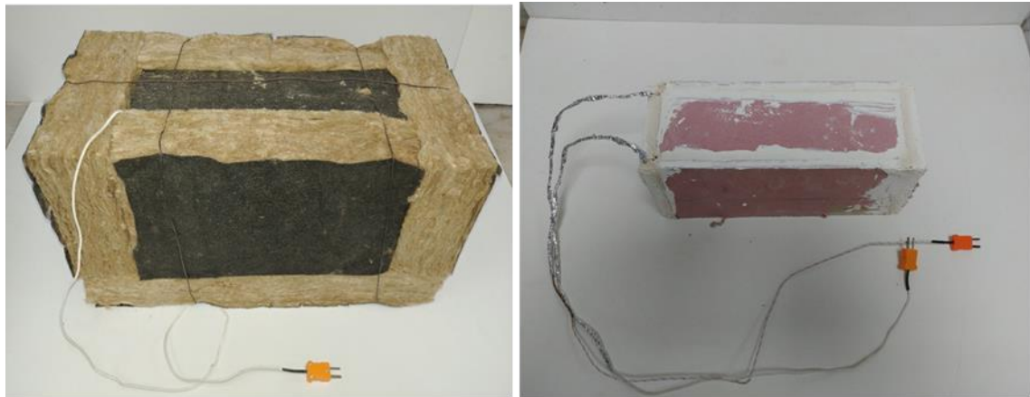
Şekil 2. Yangın yalıtımlı betonarme elemanlar
