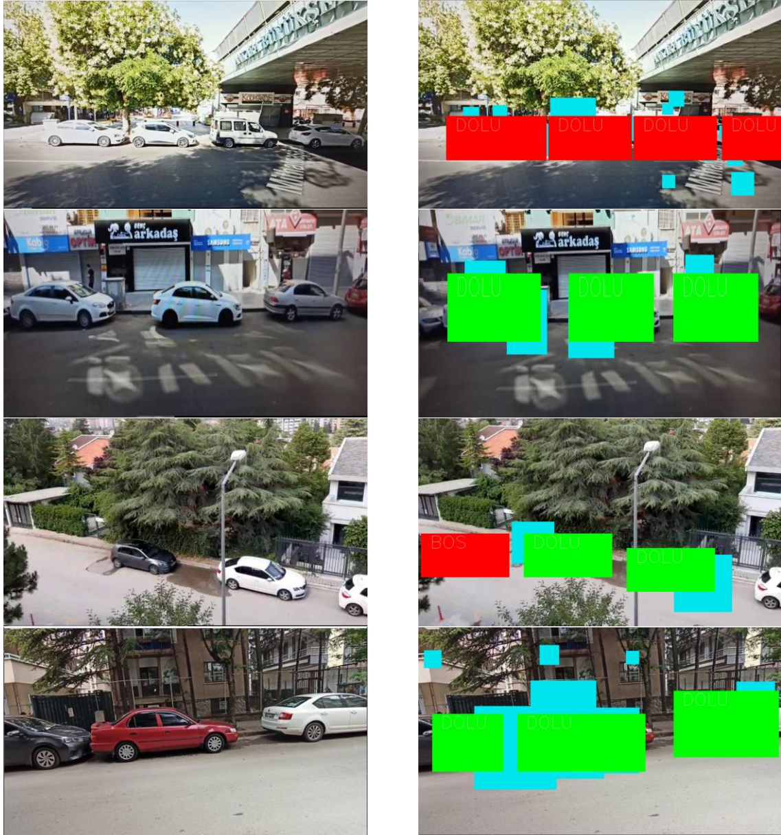
Şekil 12. Farklı park yerleri için sistemden elde edilen park yeri tespit sonuçları
