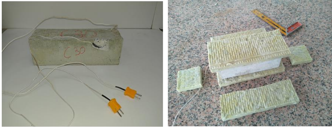
Şekil 1. Betonarme numuneleri yalıtım malzemesiyle kaplanması
