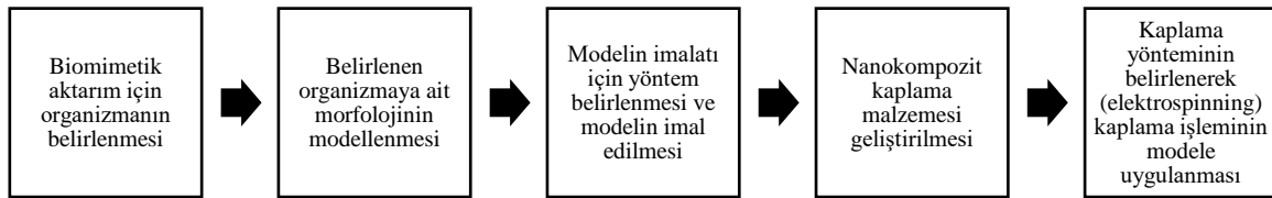
Şekil 1. Süperhidrofobik yüzey imalatında kullanılan yaklaşıma ait adımlar
